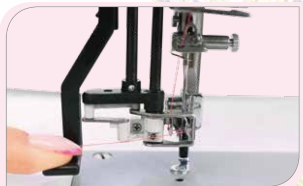
Усовершенствованный автоматический нитевдеватель ускорит заправку нити в иглу
