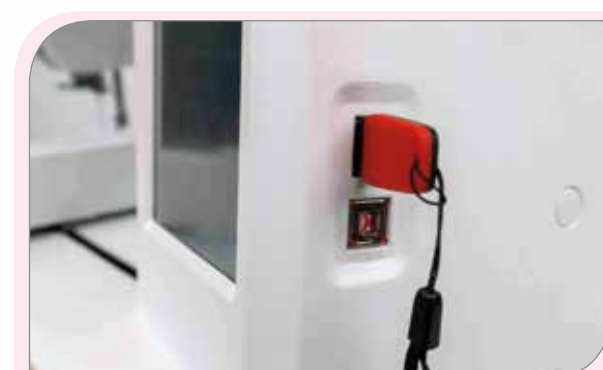
USB порт Передача дополнительных дизайнов в формате DST/DSB
